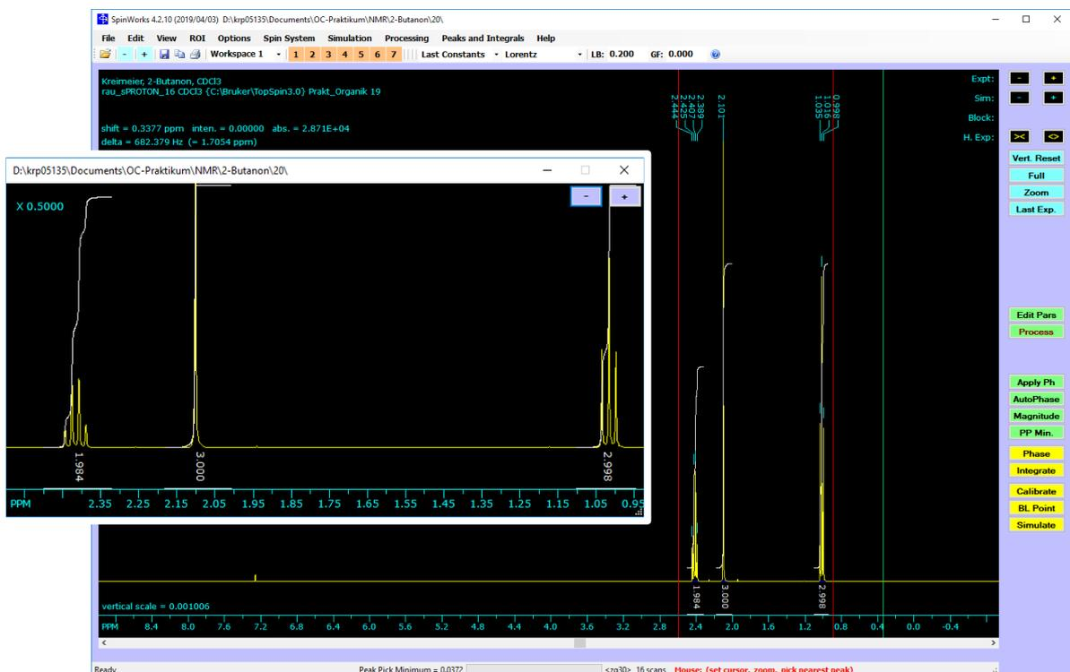
Anschließend wählen sie im Menü View den Punkt Set Fixed Limits und dort 9.5 to -0.5 ppm (proton survey) aus. Das Spektrum im Hauptfenster wird entsprechend skaliert, das Inset Fenster bleibt unverändert. Schieben Sie das Inset Fenster in einen leeren Bereich des Hauptfensters und passen evtl. die Größe nochmals an.
